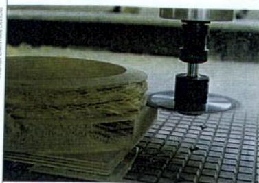
**1** Extérieur. Un bloc de bois est attaqué par la fraiseuse. Elle sculpte dans un premier temps le profil vertical et externe de la pièce. L'ensemble est contrôlé au millimètre près par ordinateur.
