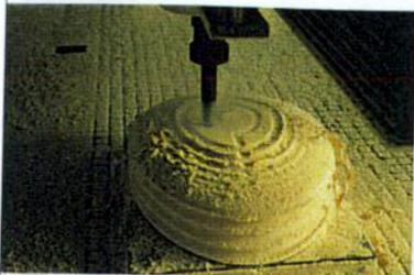
**2** Intérieur. Une fraise se charge ensuite d'entamer la face supérieure du bloc en dessinant des courbes de niveau. Plus elle se rapproche de la surface finale, et plus la machine devient précise.
